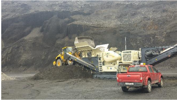
Mynd 7 Efnið var fyrst forbrotið í kjaftbrjót Metso LT 120.
